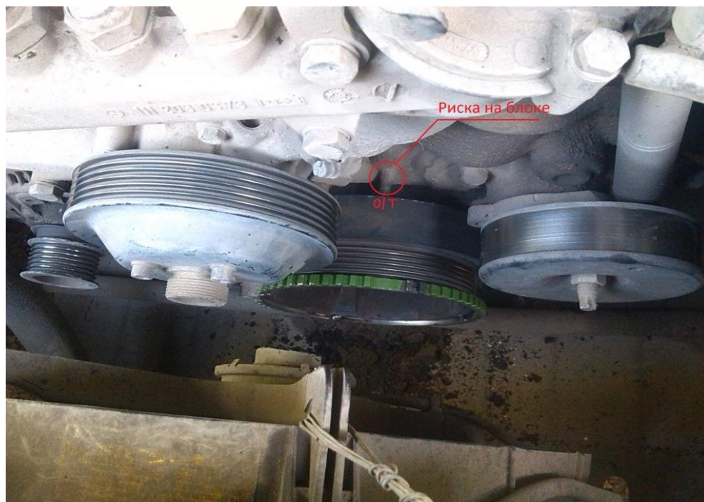
Рис. 2. Риска на блоке с выравниванием на шкиве
