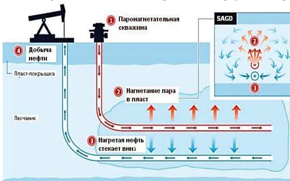
Рисунок 4 - Метод парогравитационного дренирования (SAGD).
