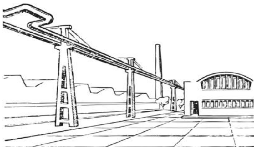
Рисунок 2. Схема компоновки тепловых сетей воздушным видом проектирования
