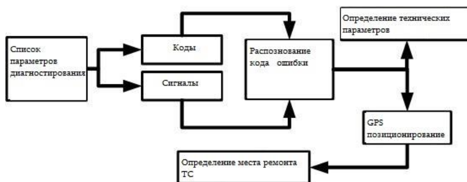
Рис. 2. Алгоритм системы мониторинга технического состояния автомобиля
